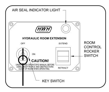
**IMPORTANT:** THE COACH MUST BE AT THE PROPER RIDE HEIGHT BEFORE EXTENDING OR RETRACTING THE GLIDE-OUT.
