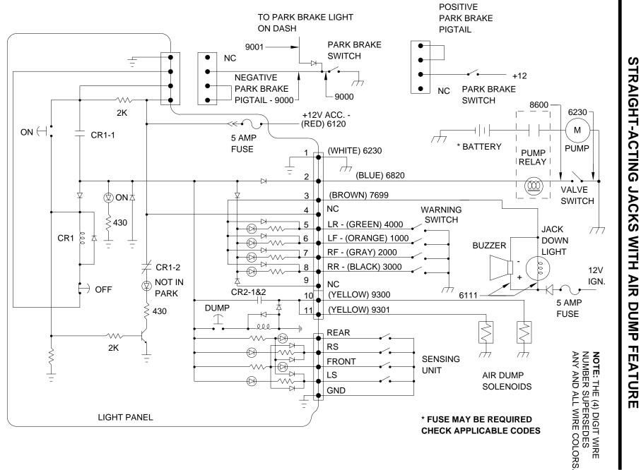
200 SERIE S ELECTRICAL LEVELING SYSTEM LIGHT SCHEMATIC PANEL
